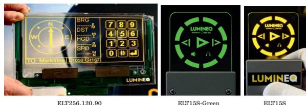
**Рис. 4. Электролюминесцентные прозрачные дисплеи TASEL**
